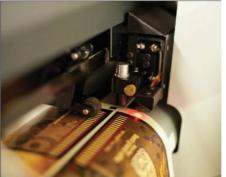
Les capteurs optiques lisent jusqu'à 3 marques pour garantir une meilleure précision
