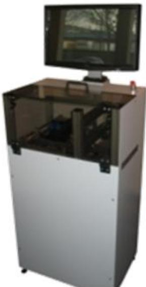
Le PrintNod 310 est un dispositif d'impression par jet d'encre destiné à être installé en sortie de tous les types de machines de mise sous plis.
